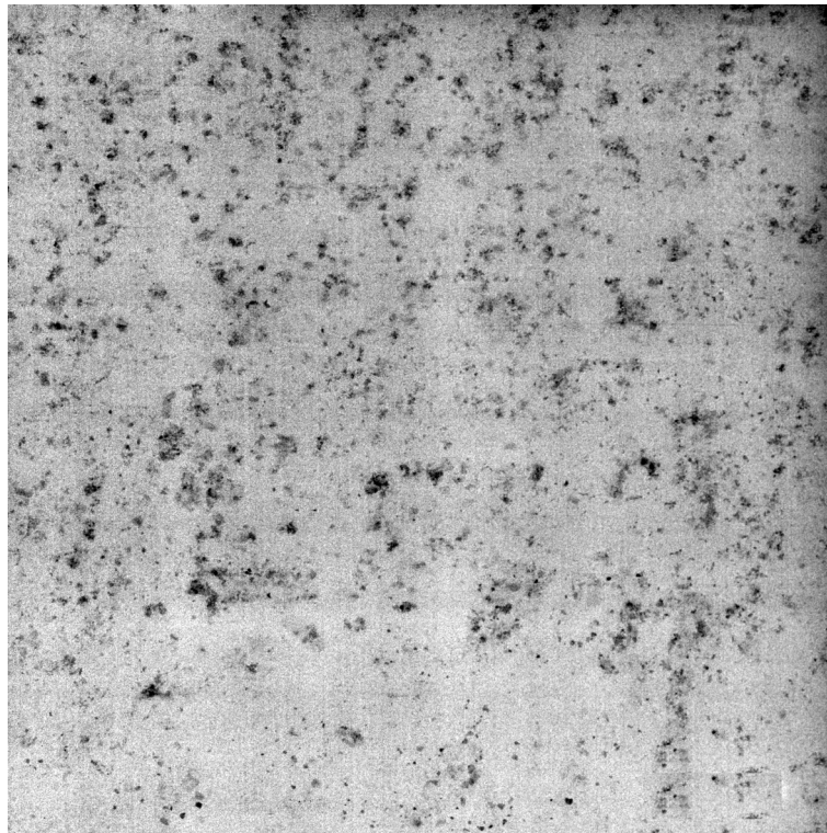
Abbildung 9: Durchstrahlungsaufnahme eines Salzsprühtestes, 100 x100 mm Seitenlänge
