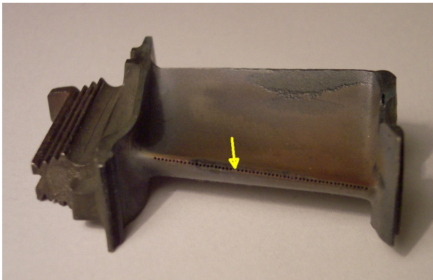
Abbildung 12: im Prinzip vergleichbare Turbinenschaufel mit Bohrungsreihe (Pfeil)
