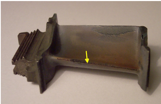
Abbildung 12: im Prinzip vergleichbare Turbinenschaufel mit Bohrungsreihe (Pfeil)
