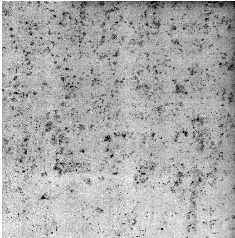
Abbildung 9: Durchstrahlungsaufnahme eines Salzsprühtestes, 100 x100 mm Seitenlänge
