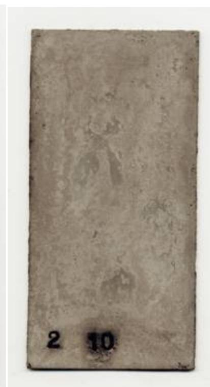
Die Proben wurden zur weiteren Begutachtung vom Rotrost befreit. Dazu werden spezielle Beizmittel eingesetzt, die das Metall selbst kaum angreifen. Es ist zu erkennen, dass der Angriff nicht homogen erfolgt.
