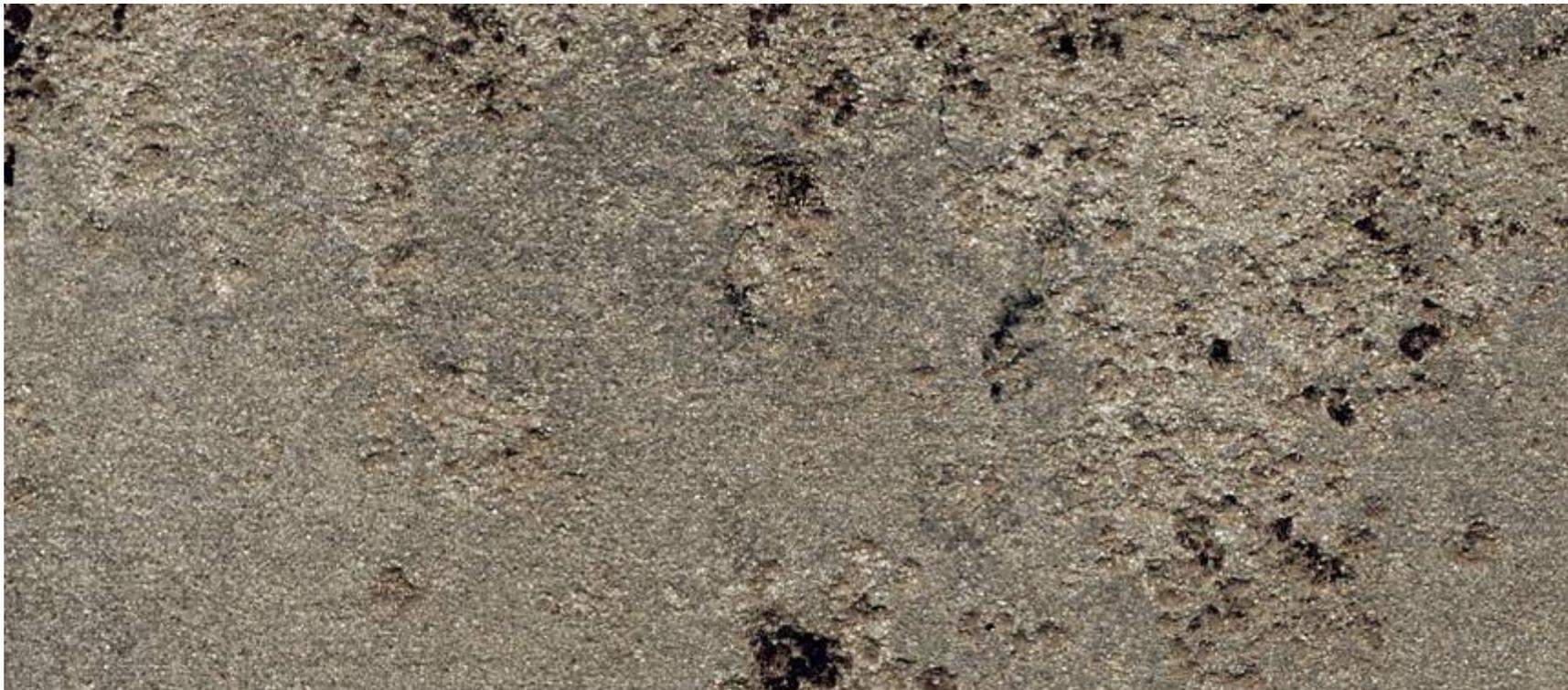
Noch deutlich mehr Löcher sind in dem unedleren Werkstoff 1.4512 zu erkennen. Eine manuelle Auswertung aller Löcher ist hier schier unmöglich.
