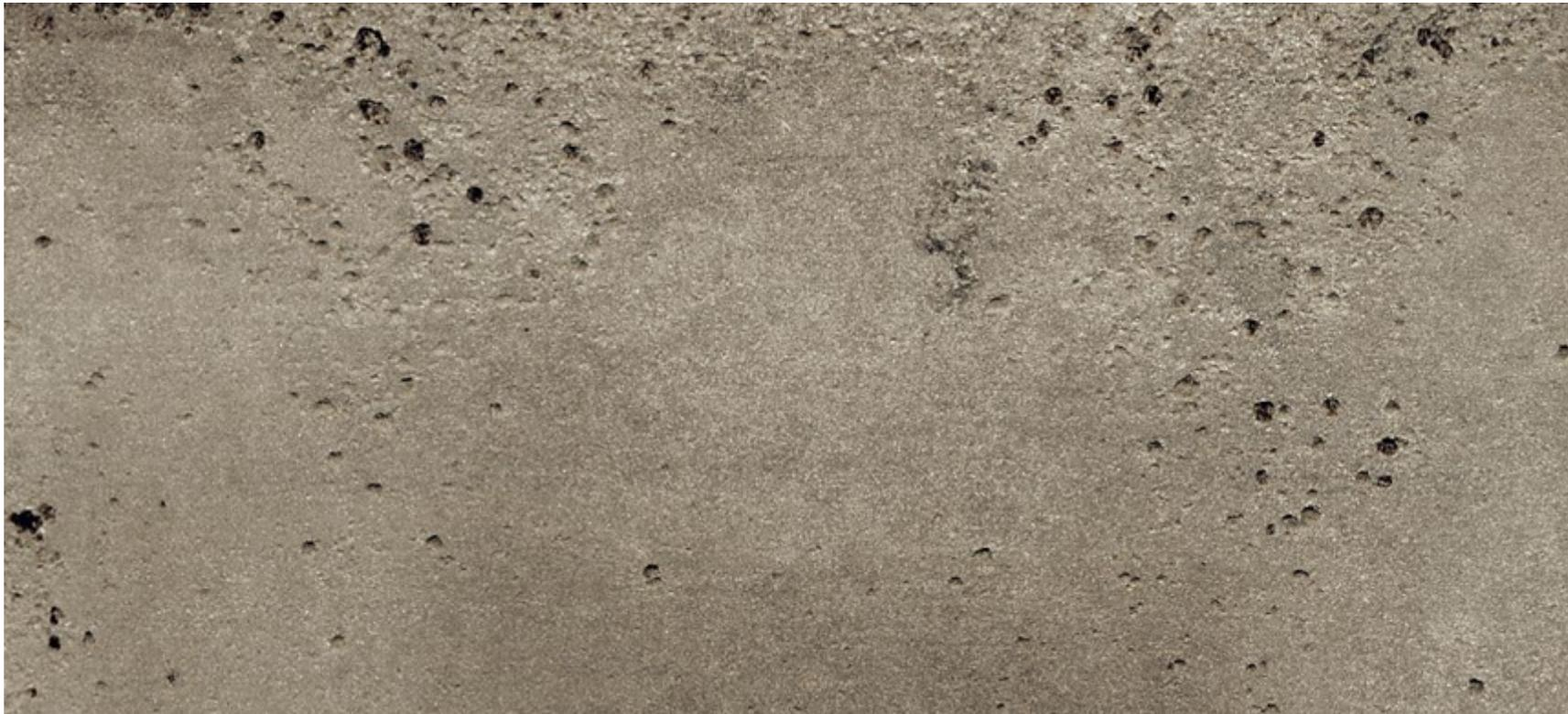
Ein vergrößerter Ausschnitt der Probe zeigt die Vielzahl der Löcher und die Häufung an manchen Flächen. Eine manuelle Auswertung des Korrosionsangriffs erfordert einen hohen Zeitaufwand.
