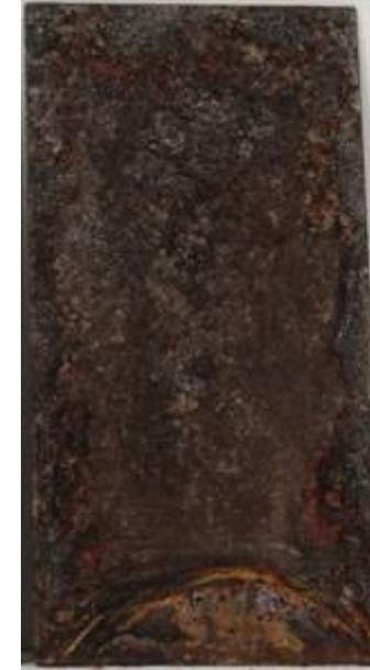
Alle Proben sind nach 10wöchiger Prüfung flächig mit Rostbraunen Ablagerungen belegt. Eine quantitative Abschätzung des Korrosionsangriffs lässt sich kaum durchführen. Es ist im Ansatz zu erkennen, dass die Ablagerungen bei dem Werkstoff 1.4512 etwas dicker sind. Dies lässt auf eine stärkere Korrosion schließen.
